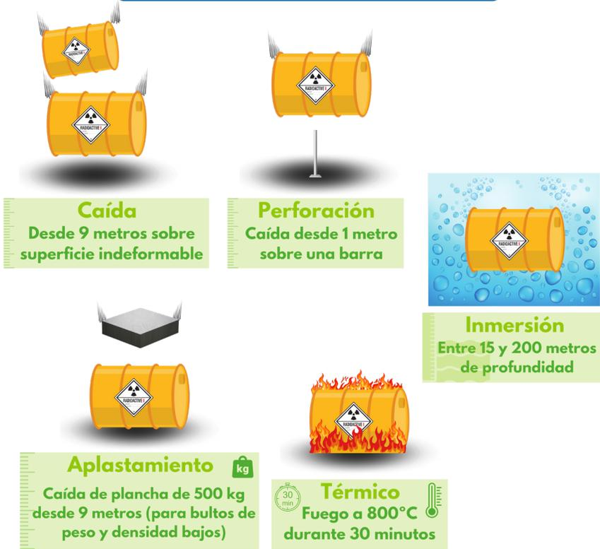
Figura 5.13: (b) Pruebas de seguridad de los bultos – Ensayos de condiciones de accidente.
