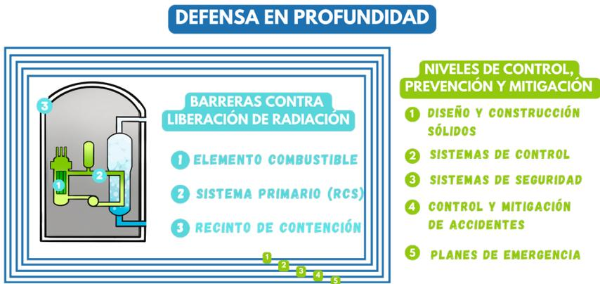
Figura 4.1: Protección multibarrera: *Defensa en profundidad*.
